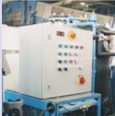
Absauganlage für das FCKW/Öl-Kühlmittel
