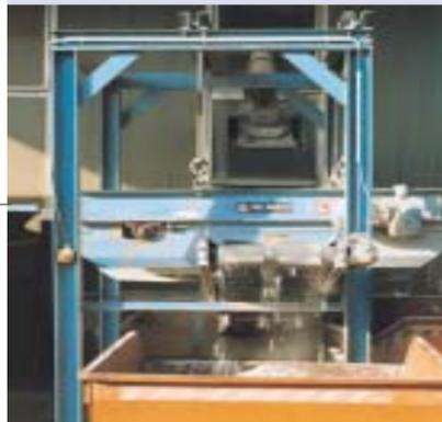
Sortiertechnik für die Trennung der Fraktionen Fe und Ne
